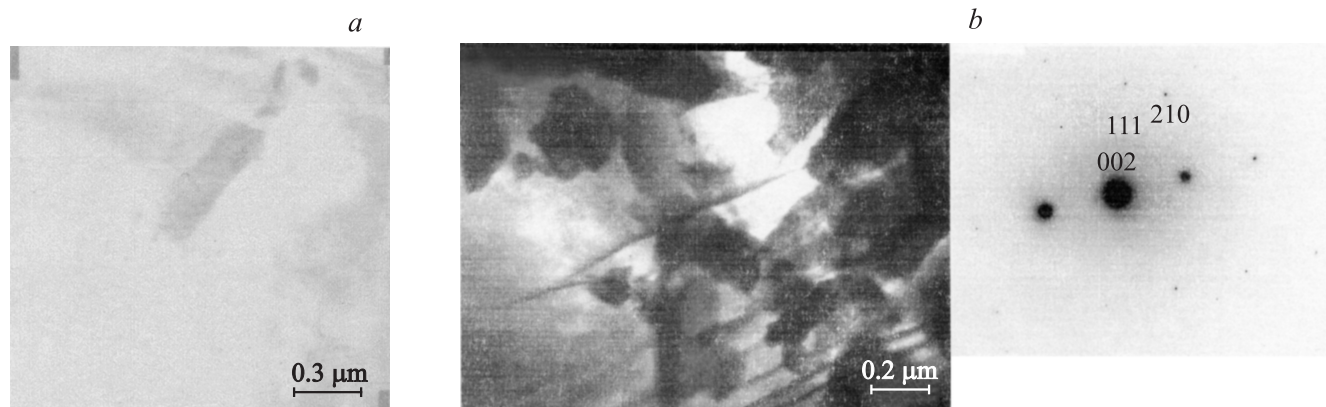
Рис. 6. a) Светлопольное изображение фольги кристалла \text{Fe}_{0.4}\text{TiSe}_2 после отжига при 330^\circ\text{C} в течение недели. b) Светлопольное изображение и соответствующая микродифракционная картина кристалла \text{Fe}_{0.4}\text{TiSe}_2 , подвергнутого ступенчатому отжигу.
