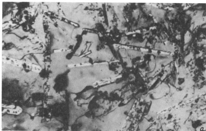
Рис. 2. а) Оптический снимок поверхности пленки \text{Bi}_2\text{Sr}_2\text{CaCu}_2\text{O}_y : подвергнутой термообработке в атмосфере воздуха при T = 1140 \text{ K} в течение 30 мин ( \times 1500 ). б) Снимок в характеристических лучах \text{BiL}\alpha участка ( 200 \times 200 \text{ мкм} ) пленки \text{Bi}_2\text{Sr}_2\text{CaCu}_2\text{O}_y после термообработки при T_0 = 1140 \text{ K} в течение 120 мин.
