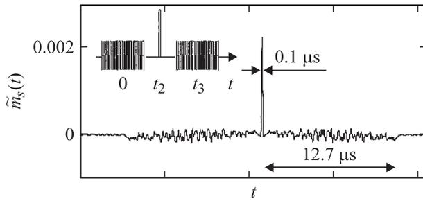
**Рис. 3.** Временная диаграмма импульсов возбуждения алгоритма Дельта 2 (на вставке) и комплексная огибающая стимулированного эха в линейном режиме.
