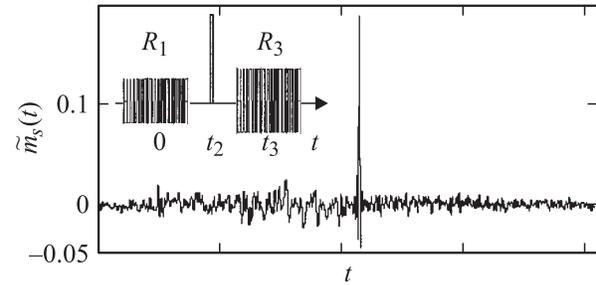
**Рис. 4.** Временная диаграмма импульсов возбуждения алгоритма Дельта 2 (на вставке) и комплексная огибающая стимулированного эха в нелинейном режиме.
