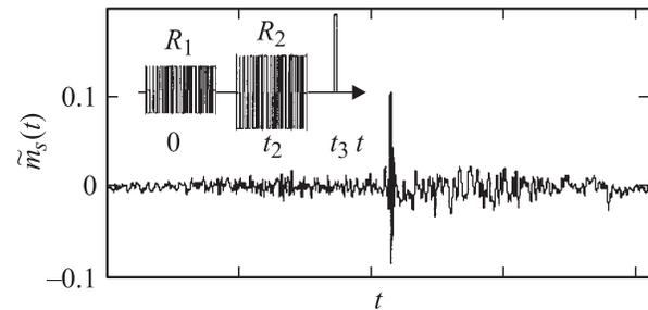
**Рис. 5.** Временная диаграмма импульсов возбуждения алгоритма Дельта 3 (на вставке) и комплексная огибающая стимулированного эха в нелинейном режиме.
