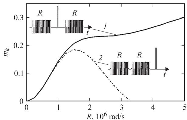
**Рис. 6.** Временные диаграммы импульсов возбуждения алгоритмов Дельта 2 (1) и Дельта 3 (2) и соответствующие амплитудные характеристики зависимости корреляционного пика комплексной огибающей стимулированного эха от амплитуды  $R$  псевдослучайных импульсов.
