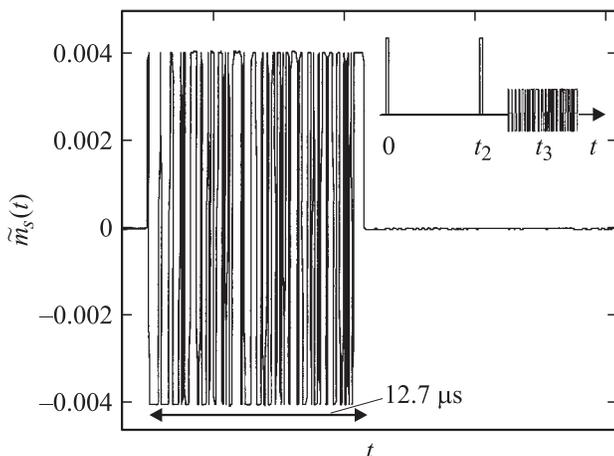
Рис. 1. Временная диаграмма импульсов возбуждения (на вставке) и комплексная огибающая стимулированного эха в линейном режиме.
