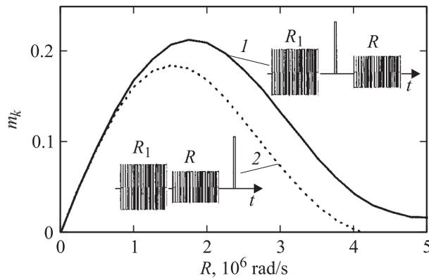
**Рис. 7.** Временные диаграммы импульсов возбуждения алгоритмов Дельта 2 (1) и Дельта 3 (2) и соответствующие амплитудные характеристики зависимости корреляционного пика комплексной огибающей стимулированного эха от амплитуды  $R$  псевдослучайных импульсов при амплитуде  $R_1 = 1.5 \cdot 10^6$  rad/s.
