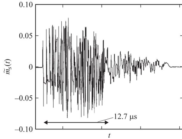
Рис. 2. Комплексная огибающая стимулированного эха в нелинейном режиме.
