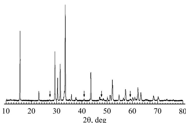
**Рис. 1.** Дифрактограмма  $\text{Yb}_{0.82}\text{Sr}_{0.18}\text{Mn}_{0.85}\text{Fe}_{0.15}\text{O}_3$ . Стрелками отмечены рефлексы, соответствующие орторомбической фазе  $\text{Sr}(\text{Mn},\text{Fe})\text{O}_3$ .
