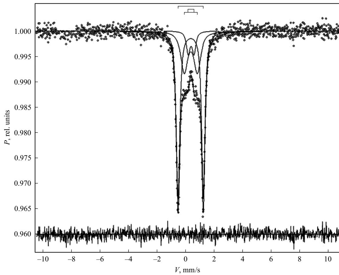
**Рис. 4.** Мессбауэровский спектр  $\text{Yb}_{0.82}\text{Sr}_{0.18}\text{Mn}_{0.8}\text{Fe}_{0.2}\text{O}_3$  ( $T = 295 \text{ K}$ ).
