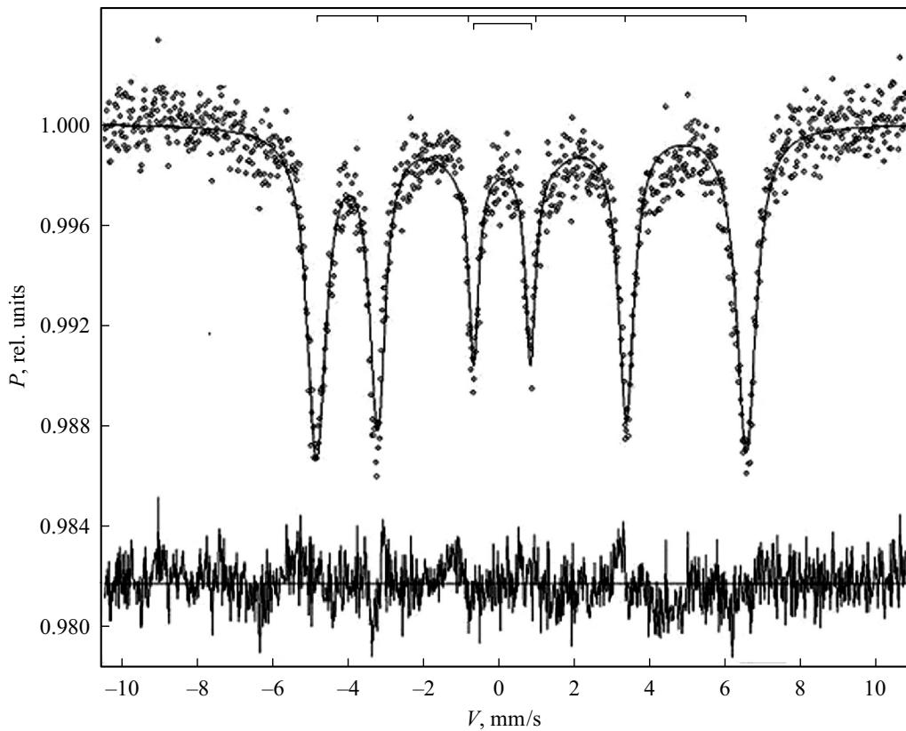
**Рис. 5.** Мессбауэровский спектр  $\text{Yb}_{0.82}\text{Sr}_{0.18}\text{Mn}_{0.8}\text{Fe}_{0.2}\text{O}_3$  ( $T = 80 \text{ K}$ ).
