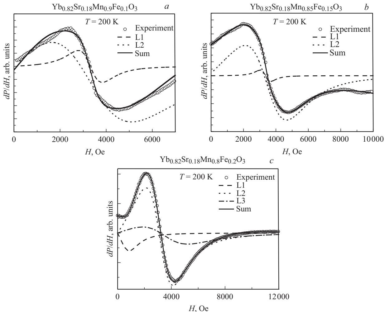
**Рис. 6.** Вид спектра ЭПР в  $\text{Yb}_{0.82}\text{Sr}_{0.18}\text{Mn}_{1-x}\text{Fe}_x\text{O}_3$  при температуре  $T = 200\text{ K}$  для (a)  $x = 0.1$ ; (b)  $x = 0.15$ ; (c)  $x = 0.2$ . Символы — экспериментальные данные, линии — теоретический расчет.
