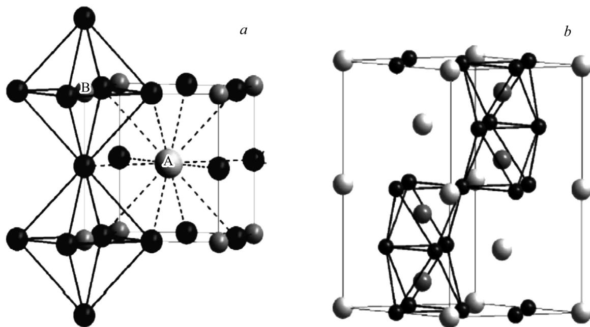
**Рис. 2.** Структуры орторомбического (a) и гексагонального (b)  $\text{SrMnO}_3$ . Ионы кислорода показаны черными, ионы марганца — темно-серыми, ионы стронция/железа — светло серыми сферами.
