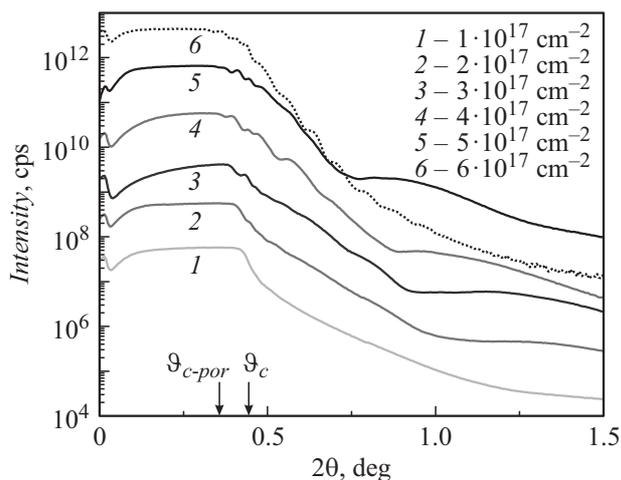
**Рис. 1.** Экспериментальные кривые рентгеновской рефлектометрии от подложки Si(001) после ПИИИ  $\text{He}^+$  с энергией 5 keV. Си-излучение. Для наглядности кривые смещены по оси ординат.
