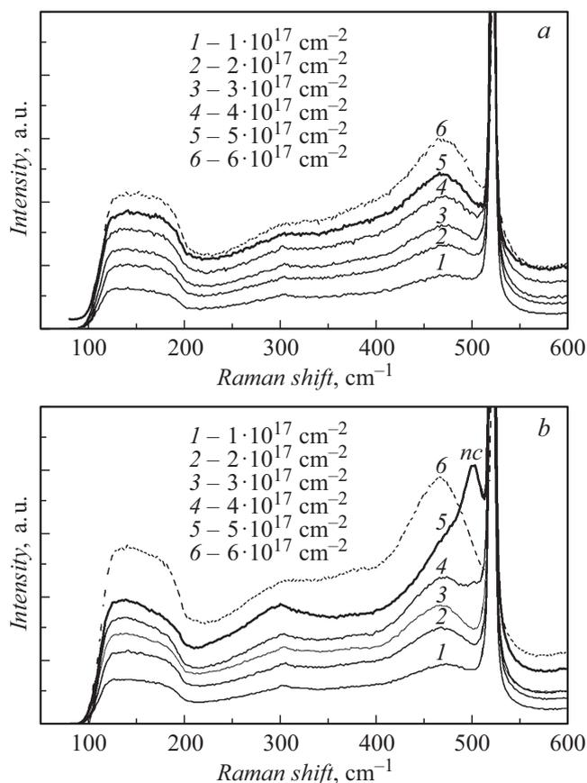
**Рис. 3.** Спектры КРС кремния после имплантации ионов  $\text{He}^+$  с дозами от  $1 \cdot 10^{17}$  до  $6 \cdot 10^{17} \text{ cm}^{-2}$  (1–6), возбужденные лазером с длиной волны 532 nm и мощностями 1 (a) и 18 mW (b).
