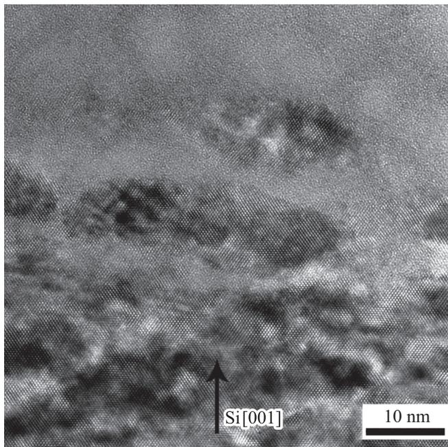
**Рис. 2.** ПЭМ-изображение высокого разрешения микроструктуры пористого кристаллического слоя Si(001) с нанокристаллами после имплантации ионов  $\text{He}^+$  с энергией 5 keV и дозой  $5 \cdot 10^{17} \text{ cm}^{-2}$  и термического отжига при  $800^\circ\text{C}$ .
