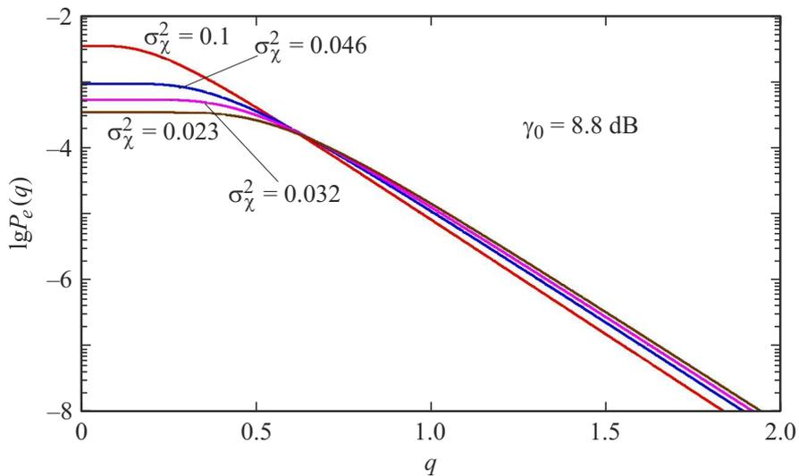
Рис. 2. Вероятности ошибок приема сигнала в режиме прерывистого излучения в зависимости от нормированного уровня порога  $q$  при постоянной энергии символа сигнала на выходе передатчика и различных значениях дисперсии  $\sigma_\chi^2$ .
