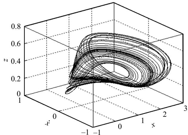
**Рис. 1.** Фазовый портрет индивидуального генератора Кислова–Дмитриева в хаотическом режиме.  $T = 10$ ,  $Q = 20$ ,  $M = 2.75$ ,  $\omega_0 = 0.5$ .
