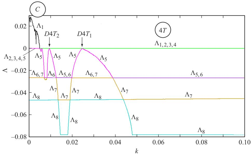
**Рис. 2.** Зависимость старших показателей Ляпунова системы (1) от параметра связи квазипериодической и хаотической подсистем  $k$ .  $\mu = 0.25, \Delta = 3$ . Параметры генератора Кислова–Дмитриева  $M = 2.75, T = 10, Q = 20, \omega_0 = 0.5$ .
