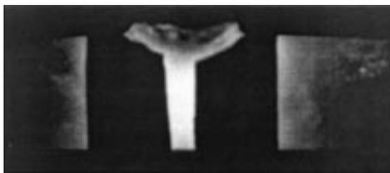
**Рис. 4.** Свечение ВЧ разряда, когда  $N/p > 5 \cdot 10^{20} \text{ м}^{-3} \cdot \text{Па}^{-1}$ . Максимальное охлаждение плазмы не достигнуто.
