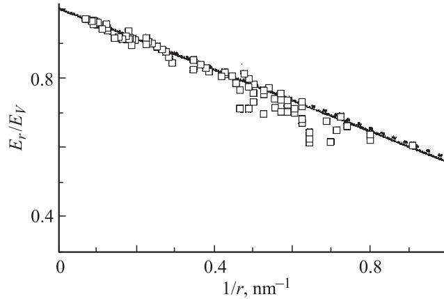
Размерная зависимость энергии образования вакансий для малых частиц золота (□ — вычисления по понижению температуры плавления [8] с использованием выражений (4) и (5); сплошная линия соответствует выражению (8); пунктир — выражению (10) [22]).
