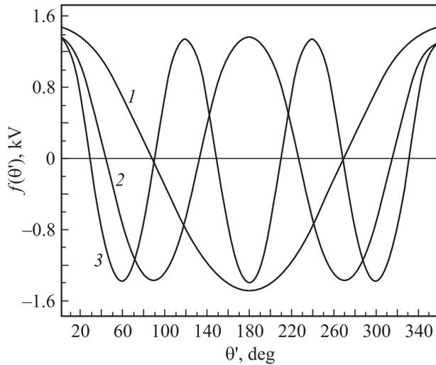
**Рис. 2.** Распределение граничного потенциала  $f(\theta')$  при бесконечном числе проводников для рассмотренных в примере гармоник поля: 1 —  $V_1 \cos \theta'$ ; 2 —  $V_2 \cos 2\theta'$ ; 3 —  $V_3 \cos 3\theta'$ . При конечном числе проводников ( $n = 36$ ) вместо сплошных кривых будут дискретные последовательности точек через каждый шаг ( $10^\circ$ ) изменения азимута.
