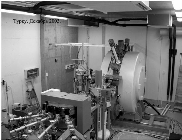
Рис. 1. Циклотрон СС-18/9.
