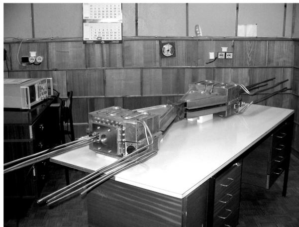
**Рис. 17.** Общий вид ускоряющей системы циклотрона СС-12 (на стенде).
