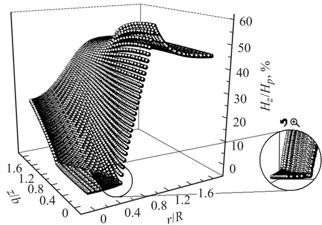
**Рис. 3.** Трехмерный график карты распределения осевой составляющей напряженности полного магнитного поля  $H_z(r, z)$ . Значения напряженности указаны в процентах от величины напряженности поля полного проникновения  $H_p$ . Внешнее аксиально-направленное поле  $H_0$  составляет  $H_0 = 0.45H_p$ . Радиус проникновения поля при  $z = 0$  составляет  $a = 0.5R$ .
