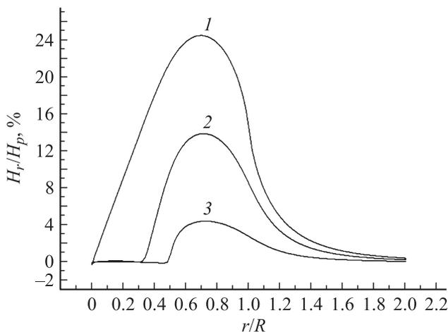
**Рис. 6.** Радиальная составляющая полного поля цилиндра  $H_r(r)$  в плоскостях  $z = b$  (кривая 1),  $z = 0.6b$  (кривая 2) и  $z = 0.2b$  (кривая 3). Величина поля указана в процентах от  $H_p$ . Радиус проникновения поля при  $z = 0$  составляет  $a = 0.5R$ .
