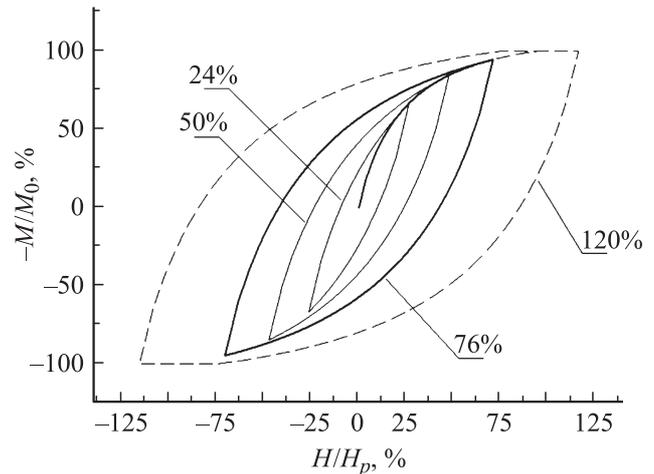
**Рис. 8.** Начальная кривая намагниченности и петли гистерезиса намагниченности для разных значений максимальных полей цикла намагничивания  $H_{max}$ . Значение поля указано в процентах от  $H_p$ , а величина намагниченности указана в единицах намагниченности насыщения.
