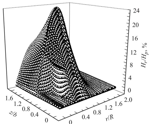
**Рис. 4.** Трехмерный график карты распределения радиальной составляющей напряженности полного магнитного поля  $H_r(r, z)$ . Значения напряженности указаны в процентах от величины напряженности поля полного проникновения  $H_p$ . Внешнее аксиально-направленное поле  $H_0$  составляет  $H_0 = 0.45H_p$ . Радиус проникновения поля при  $z = 0$  составляет  $a = 0.5R$ .
