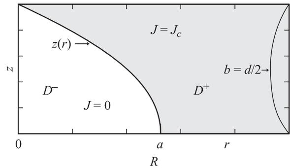
Рис. 1. Сечение четверти сверхпроводящего цилиндра. Закрашенная область  $D^+$  несет ток с критической плотностью  $J_c$  и отделена от области  $D^-$  поверхностью, заданной уравнением  $z(r)$  (4).
