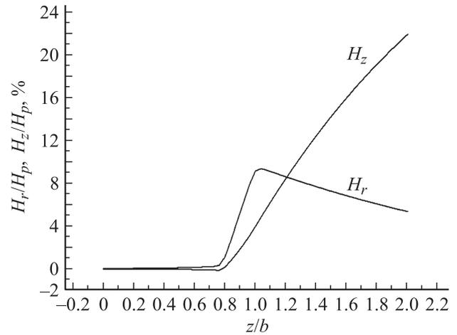
**Рис. 7.** Аксиальная и радиальная составляющие полного поля цилиндра на поверхности цилиндра  $r = 0.2R$ . Величина поля указана в процентах от  $H_p$ . Радиус проникновения поля при  $z = 0$  составляет  $a = 0.5R$ .
