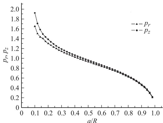
Рис. 2. Зависимость показателя степени  $p$  (уравнение (4)) для радиальной и аксиальной составляющих напряженности полного магнитного поля.
