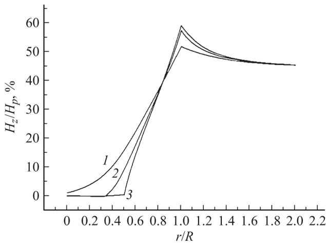
**Рис. 5.** Аксиальная составляющая полного поля цилиндра  $H_z(r)$  в плоскостях  $z = b$  (кривая 1),  $z = 0.6b$  (кривая 2) и  $z = 0$  (кривая 3). Величина поля указана в процентах от  $H_p$ . Радиус проникновения поля при  $z = 0$  составляет  $a = 0.5R$ .
