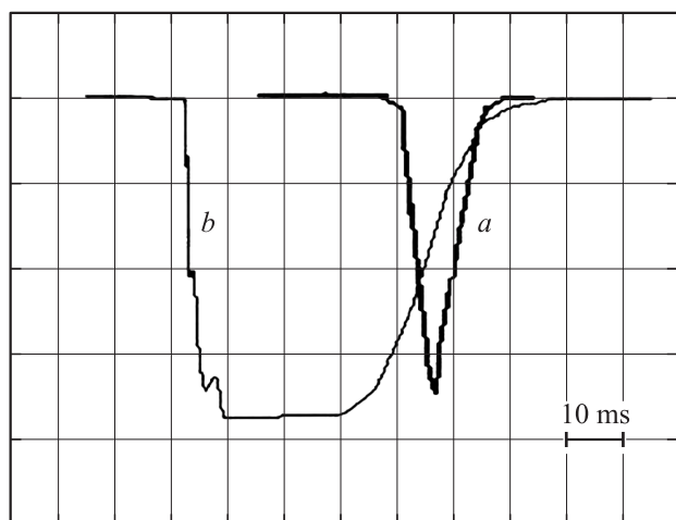
Рис. 2. Осциллограммы оптического отклика HTN-ячейки № 4 на длине волны 0.65 μm при приложении НЧ- и ВЧ-полей с напряжением 50/38 V и длительностью 20/100 ms в форме колебаний: a — синусоида, b — меандр.
