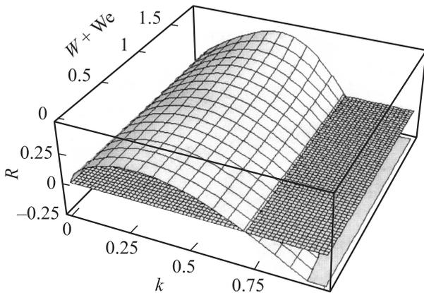
**Рис. 4.** Зависимость резонансного сомножителя  $R$  от безразмерного волнового числа  $k$  и суммы параметров  $We + W$ . Рассчитано при  $\rho = 0.001$ .
