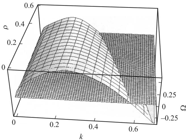
**Рис. 1.** Зависимость резонансного множителя  $\Omega \equiv 3\omega_0(k) - \omega_0(3k)$  от безразмерного волнового числа  $k$  и отношения плотностей  $\rho$ , пересеченная нулевой плоскостью. Рассчитано при  $We + W = 1.2$ .
