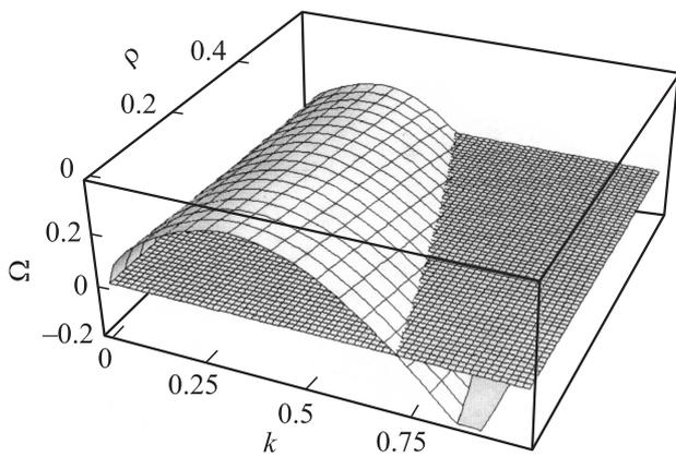
**Рис. 3.** Зависимость резонансного множителя  $R \equiv 2\omega_0(k) - \omega_0(2k)$  от безразмерного волнового числа  $k$  и отношения плотностей  $\rho$ , пересеченная нулевой плоскостью. Рассчитано при  $We + W = 1$ .
