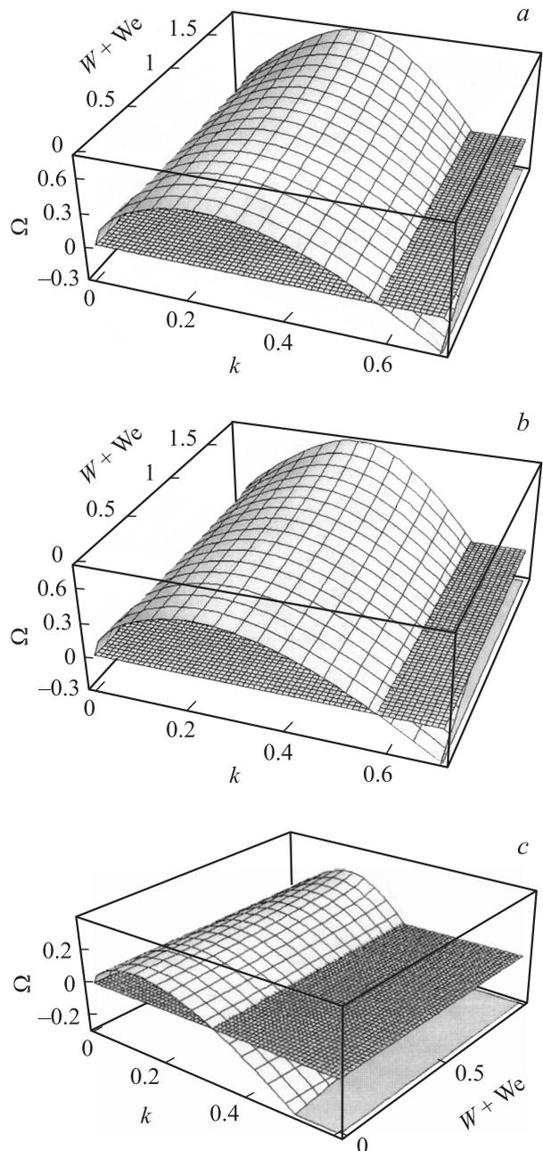
**Рис. 2.** Зависимости резонансного множителя  $\Omega$  от безразмерного волнового числа  $k$  и суммы параметров  $We + W$ . Рассчитано при: *a* —  $\rho = 0.001$ , *b* —  $\rho = 0.1$ , *c* —  $\rho = 0.7$ .
