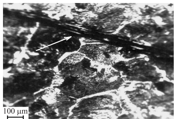
Рис. 5. Фотография полосы локализованной деформации. Стрелка показывает полосу локализации.
