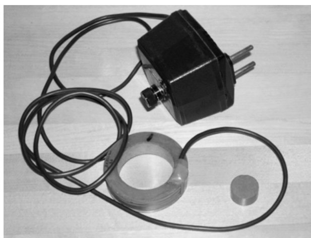
Рис. 4. Электродинамический подвес, включающий катушку, магнит и блок питания со встроенной схемой управления.
