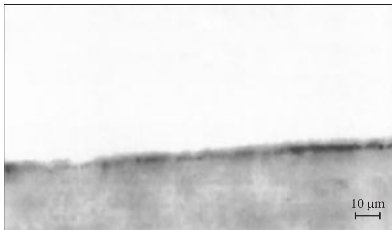
Рис. 3. Оптическое изображение торца кремния, обработанного 15 min (увеличение \times 500 ).
