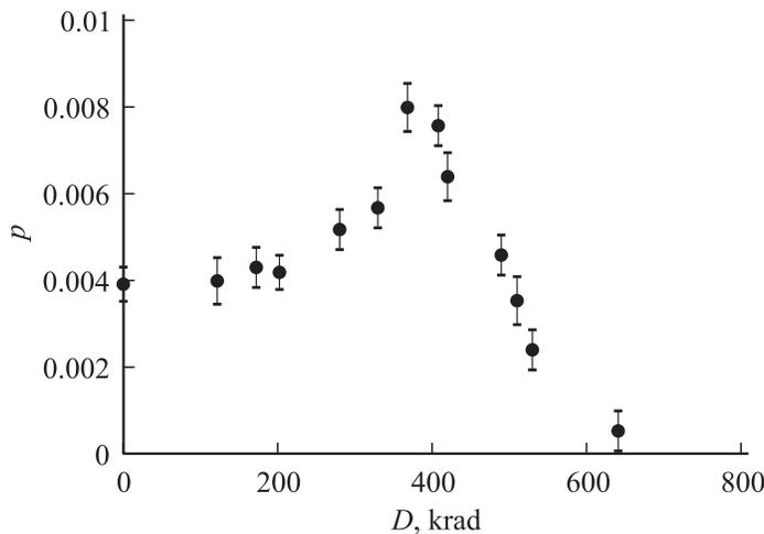
Зависимость вероятности взрыва азид свинца ( $p$ ) от дозы предварительного облучения ( $D$ ) при обработке электронным ускорителем.
