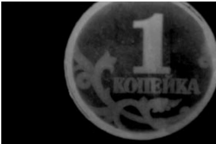
**Рис. 2.** Изображение поверхности образца под положительным электродом (в качестве электрода использовалась монета) при просветлении в электрическом поле. Фотоснимок сделан со стороны отрицательного электрода.
