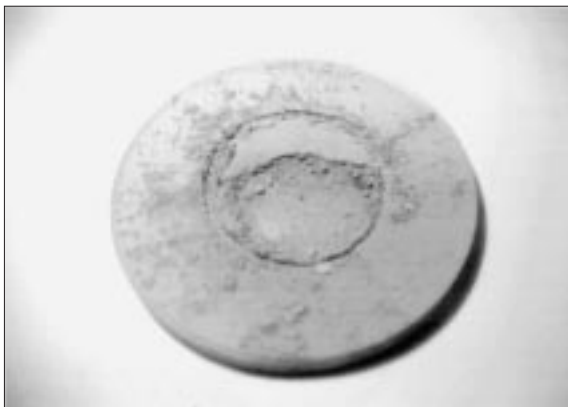
Рис. 3. Нижняя кварцевая пластинка и порошок PbO после оптического инициирования разряда. Разбрасывание порошка обусловлено нагревом газа.
