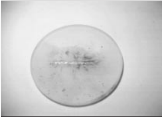
Рис. 2. Верхняя кварцевая пластинка после оптического инициирования разряда в порошке РbО. Инициирование проведено с помощью двух ксеноновых ламп, расположенных параллельно друг другу. След на кварце указывает на ориентацию ламп.
