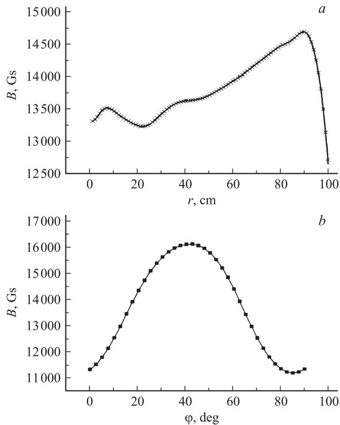
**Рис. 2.** Распределение:  $a$  — среднего измеренного и сглаженного магнитных полей по радиусу;  $b$  — измеренного и сглаженного магнитных полей по азимуту ( $R = 51$  cm).
