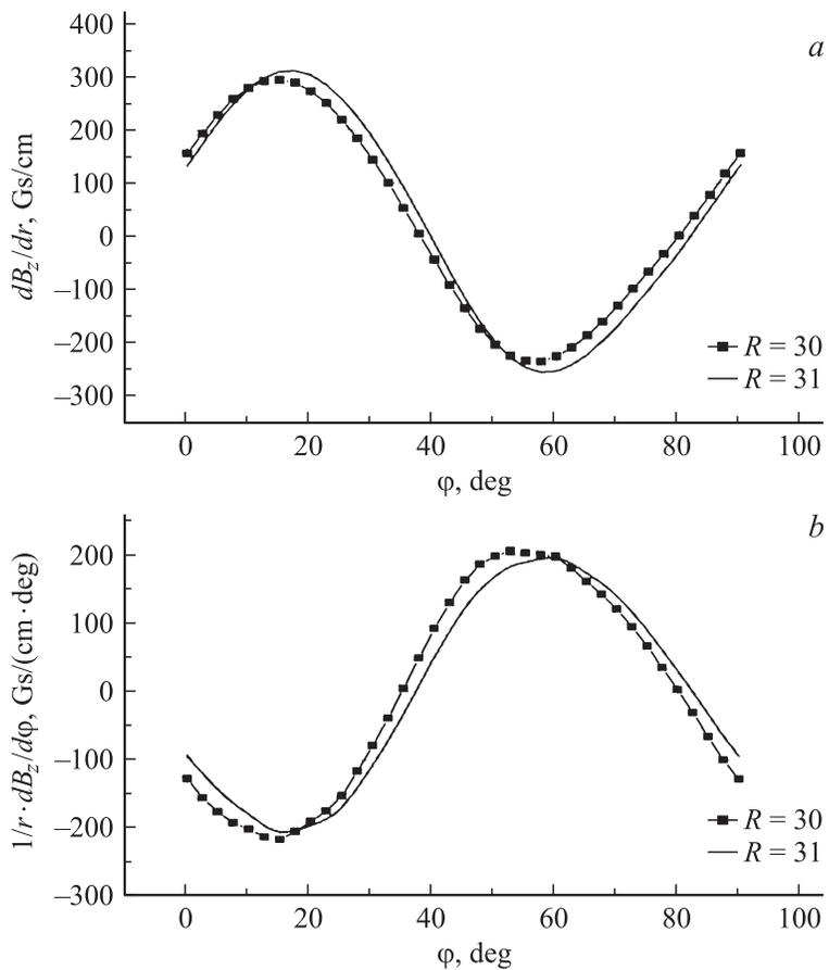
**Рис. 3.** Зависимость производной индукции магнитного поля: *a* — по радиусу от угла ( $R = 30$  см и  $R = 31$  см); *b* — по азимуту от угла ( $R = 30$  см и  $R = 31$  см).
