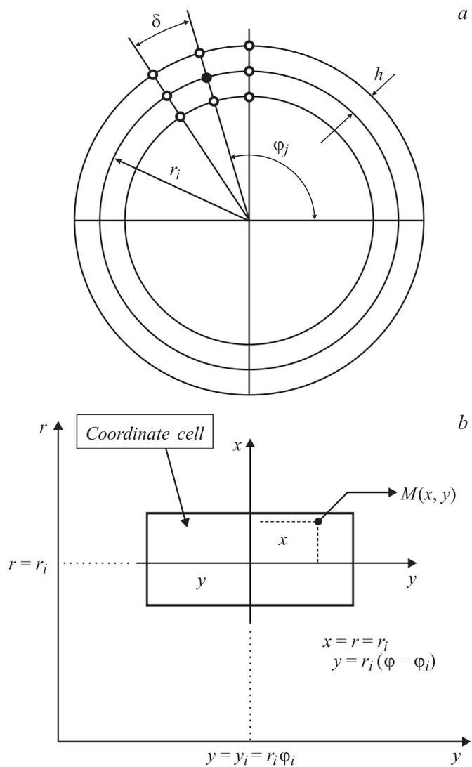
**Рис. 1.** *a* — координатная сетка; *b* — координатная ячейка, ограниченная линиями координатной сетки.
