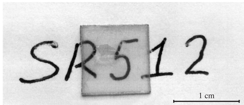
Рис. 1. GaN/Al 2 O 3 , полученный при температуре источника 750°C.
