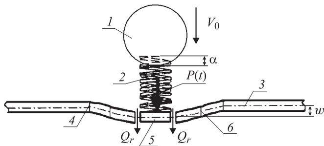
**Рис. 1.** Схема ударного взаимодействия твердого тела и буфера, установленного на пластинке: 1 — ударник, 2 — буфер, 3 — пластина, 4 — фронт квазипродольной волны, 5 — контактная область, 6 — фронт квазипоперечной волны.
