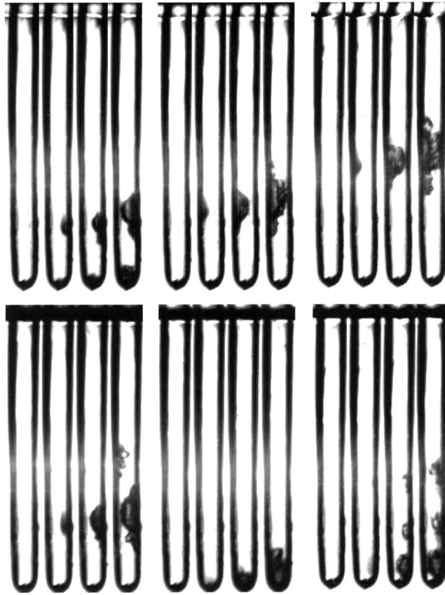
Рис. 3. Видеокадры (первые 4 кадра) появления и развития пузырька на стенке капилляра из разных видеофильмов, для разных флуктуационных центров при T = 188.0^\circ\text{C} .
