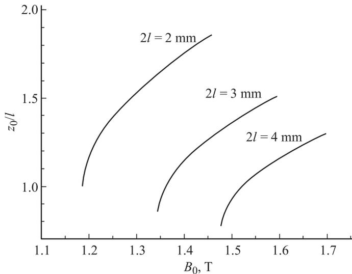
**Рис. 4.** Зависимость положения точки устойчивой левитации частиц  $z_0$  от магнитного поля при  $R_0 = 10 \text{ mm}$ ,  $r = 2 \text{ mm}$  и трех значениях зазора между полюсными наконечниками  $2l = 2, 3$  и  $4 \text{ mm}$ .
