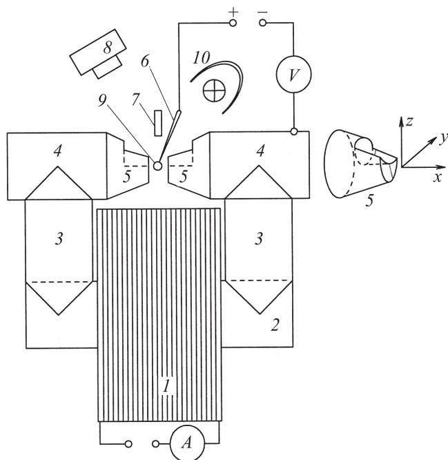
**Рис. 1.** Схема экспериментальной установки: *1* — обмотка электромагнита, *2–4* — нижний, боковые и верхние магнитопроводы, *5* — полюсные наконечники — концентраторы магнитного потока, *6* — зонд для зарядки частиц, *7* — вброс частиц, *8* — ПЗС камера, *9* — область левитации, *10* — подсветка частиц.
