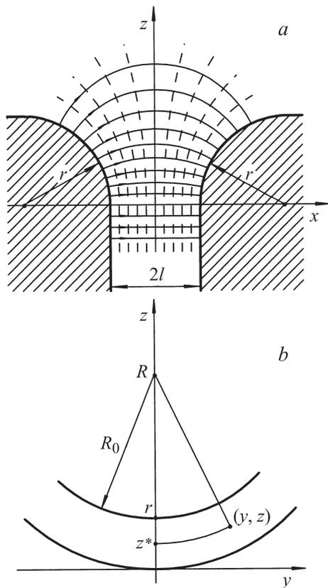
**Рис. 3.** Сечения зазора между полюсными наконечниками: *a* — плоскостью  $(x, z)$  и *b* — плоскостью  $x = \text{const} < l$ . Силовые линии магнитного поля на рис. *a* показаны тонкими сплошными линиями со стрелками, эквипотенциали — штриховыми.
