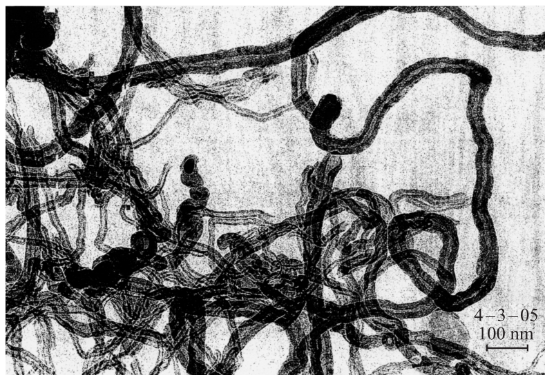
Рис. 2. Изображение очищенных многослойных углеродных нанотрубок, полученное методом просвечивающей электронной микроскопии.
