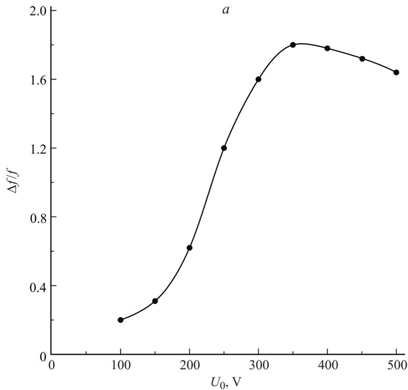
**Рис. 2.** *a* — зависимость полосы частот генерации  $\Delta f/f$  от величины ускоряющего напряжения  $U_0$ , *b* — зависимость относительной величины интегральной мощности  $P$  от величины ускоряющего напряжения  $U_0$ .
