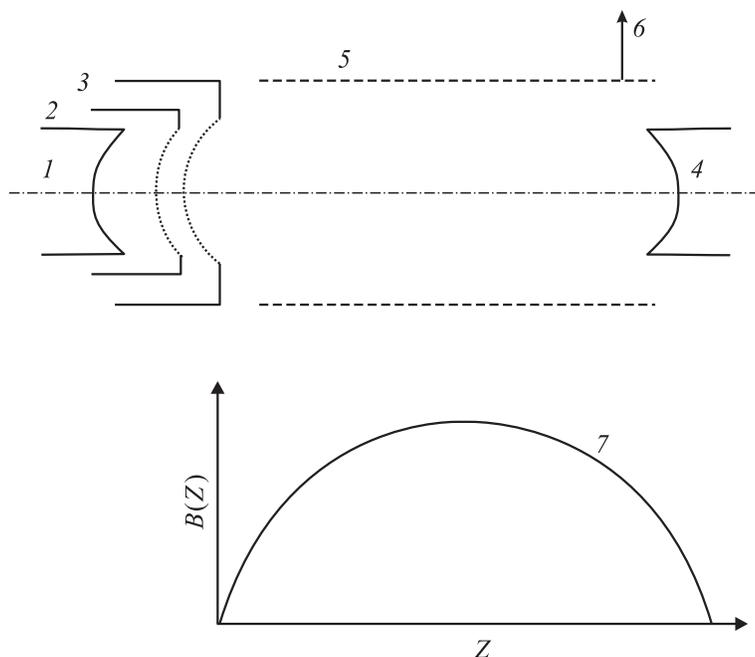
**Рис. 1.** Принципиальная схема конструкции сверхнизковольтного малогабаритного генератора хаоса на встречных пучках с вторичноэмиссионным катодом: 1 — катод; 2 — экранирующая сетка; 3 — управляющая сетка; 4 — вторично-эмиссионный катод; 5 — съемник энергии в виде отрезка электродинамической системы, 6 — вывод энергии; 7 — схематичное изображение распределения внешнего неоднородного магнитного поля.
