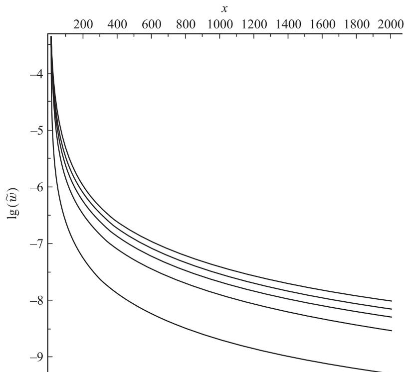
**Рис. 2.** Зависимость десятичного логарифма энергии связи электрона от аргумента дзета-функции  $x$  в формуле (6) при различных значениях эффективной фрактальной размерности  $n$ . Последовательно сверху вниз  $n = 3.9, 3.4, 3, 2.6, 2.1$ .
