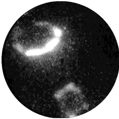
Рис. 1. Полевое электронное изображение иридиевого острья с пленкой графена после напыления цезия ( V = 1.8 \text{ kV} ).
