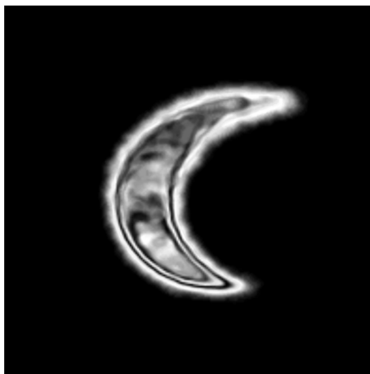
Рис. 2. Фотометрическое изображение пламени, распространяющегося в стратифицированной горючей газовой смеси.
