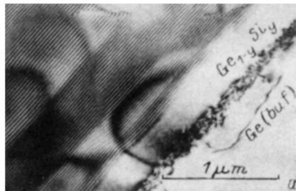
Рис. 1. Электронно-микроскопический снимок сечения CPGe—Ge 0.87 Si 0.13 с периодом 50 нм, выращенной на подложке Ge [111] через буферные слои Ge и Ge 0.94 Si 0.06 : а — общий вид косого шлифа структуры, б — граница гетероперехода буферный слой Ge—буферный слой Ge 0.94 Si 0.06 на косом шлифе.
