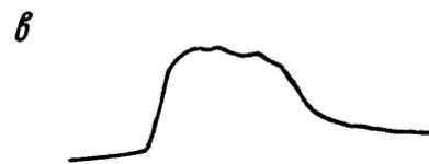
Осциллограммы записи свечения ударных фронтов в четыреххлористом углероде, помещенном за образцами.
