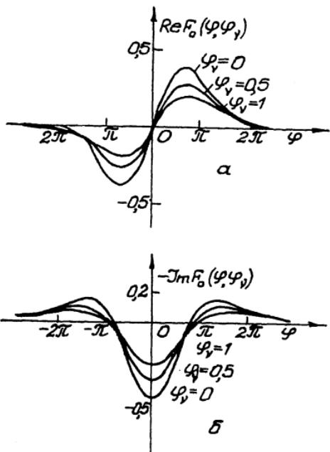
Зависимость функции  $F_0(\varphi, \varphi_y)$  от параметра рассинхронизма  $\varphi$ .
