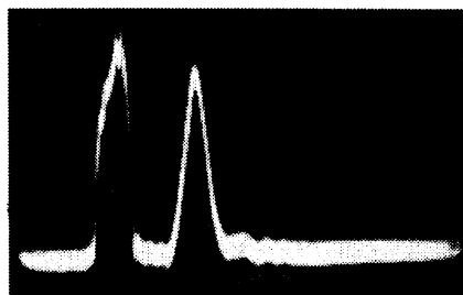
Рис. 1. Зависимость огибающей отраженного сигнала от времени для образца 1: 1-5 касательное поле,
