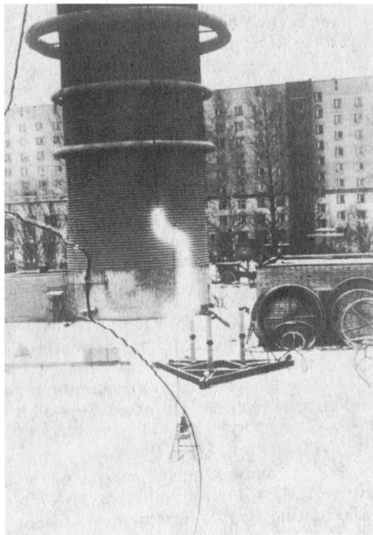
Рис. 2. Типичная траектория лазерного разряда в промежутке с макетом лазерной искры.
