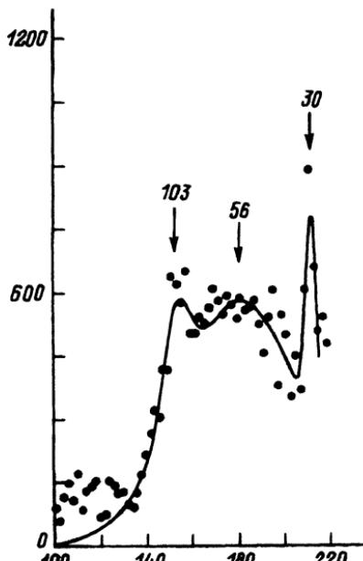
Разность спектров НРН сплавов  $VN_{0.02}H_{0.01}$  и  $VN_{0.02}$  в области примесных колебаний атомов азота и водорода.
