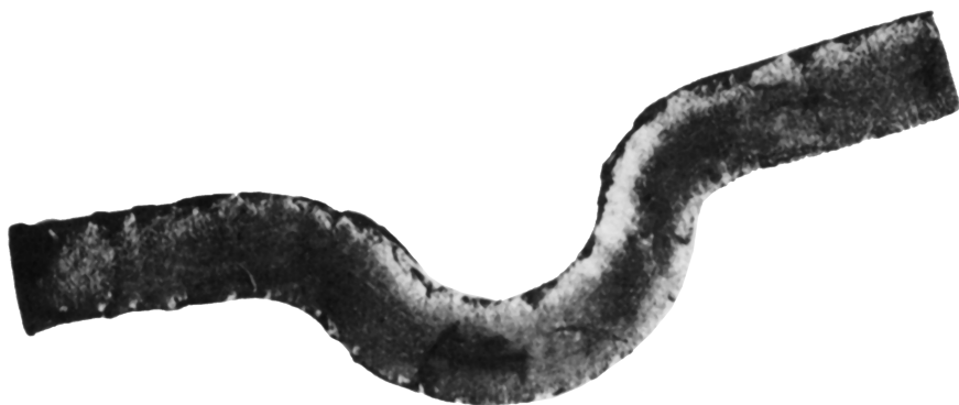
Рис. 1. \Omega -образная форма пластически деформированного образца \text{Bi}_2\text{Te}_3 после испытаний на изгиб по трехточечной схеме ( P \parallel \bar{3} , скорость деформации V = 0.05 \text{ cm/min} ). Увеличение \times 4 .
