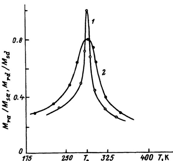
Температурные зависимости относительных остаточных намагниченостей *a*- и *d*-подрешеток феррита  $Cd_3Fe_5O_{12}$  в области  $T_c$ , полученные из мессбауэровских спектров.
