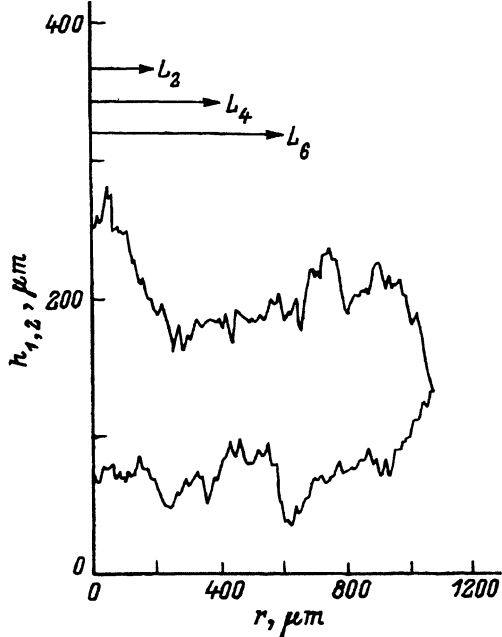
Рис. 1. Прямая и ответная половины изломов после усреднения по направлениям.
