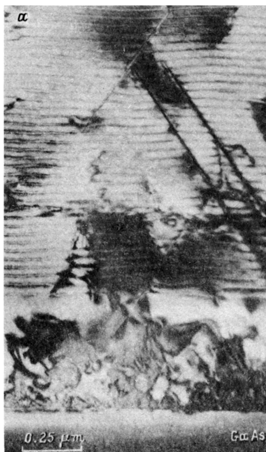
Рис. 6. Гетероструктура {100}(Cd, Zn)Te/{100}GaAs, выращенная методом МПЭ. Поперечный срез. a — светлопольное изображение, b и c — ВРЭМ-изображения чередующихся слоев CdTe/Cd 0.96 Zn 0.04 Te и границы раздела Cd 0.96 Zn 0.04 Te/GaAs соответственно.
