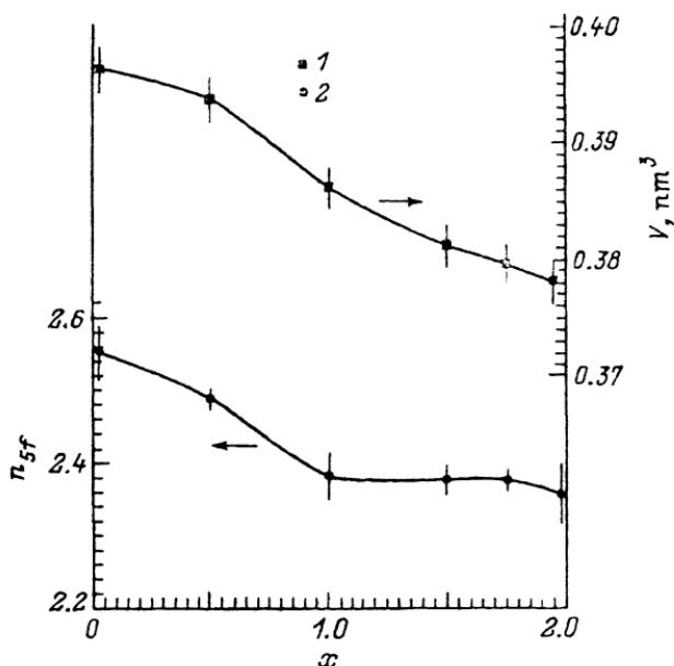
Зависимость объема элементарной ячейки  $V$  (1) и заселенности  $5f$ -оболочки урана  $n_{5f}$  (2) в  $\text{UCu}_{4+x}\text{Al}_{8-x}$  от состава  $x$ .
