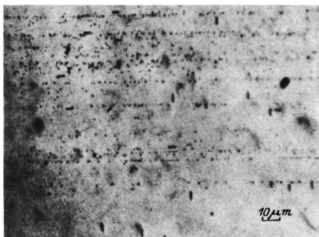
Рис. 2. Микрофотография поверхности пористого кремния, сформированного на подложке с введенными окислительными дефектами упаковки и линиями скольжения. Увеличение 625\times
