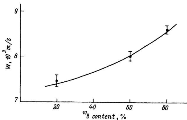
Зависимость скорости распространения продольной ультразвуковой волны в карбиде бора от концентрации изотопа  $^{10}\text{B}$ .
