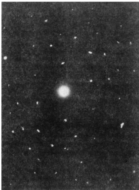
Рис. 1. Типичная электронограмма приповерхностной области GaAs (100) в просвечивающей геометрии после обработки в парах халькогенов.
