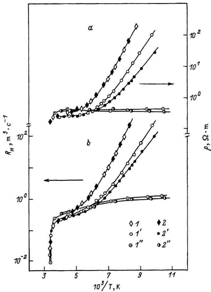
Зависимость удельного сопротивления (а) и коэффициента Холла (б) от температуры для образцов НЛГ. 1, 1', 1'' — образец 1, без обработки УЗ; 2, 2', 2'' — образец 2, подвергнутый обработке УЗ с частотой  $f = 6.4$  МГц и плотностью мощности  $W = 1$  Вт/см $^2$ . 1, 2 — до отжига; 1', 2' — после отжига при  $120^\circ$  С; 1'', 2'' — после отжига при  $210^\circ$  С.
