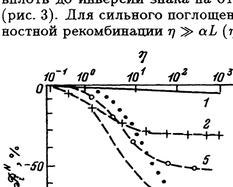
Рис. 4. Расчетные зависимости коэффициента естественного фотоплекроизма от скорости поверхностной рекомбинации в кристаллах p\text{-CdGeP}_2(\text{Cu}) при 300 К. \alpha L : 1 — 0.1, 2 — 1.1, 3, 5 — 11, 4 — 100; \alpha^{\parallel}/\alpha^{\perp} : (1-4) — 10, 5 — 4.
