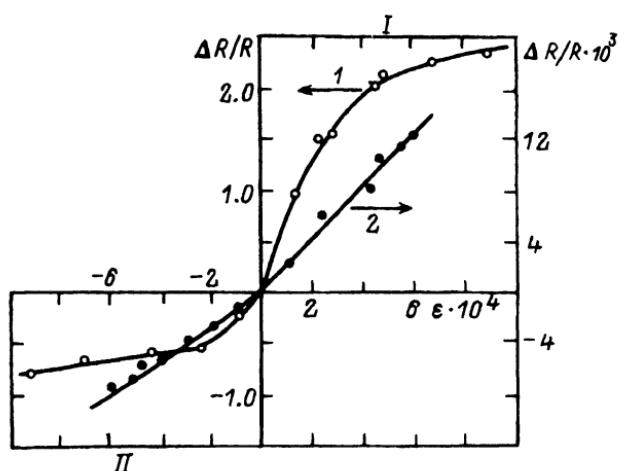
Зависимость сопротивления от деформации при комнатной температуре на блочном (1) и однородном (2) кристаллах  $2\text{CH}_3\text{MT}(\text{TCNQ})_2$ . I — растяжение, II — сжатие.
