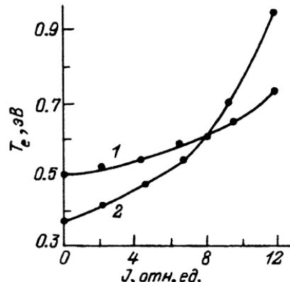
Графики зависимости температуры электронов в разряде азота от интенсивности звуковой волны при давлении 30 Тор и разрядном токе 40 мА.
