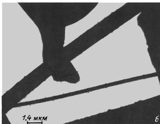
Рис. 5. Электронные микрофотографии фильтра с графитовым осадком графита МПГ-8 после облучения плазменными сгустками W = 250 \text{ кДж/м}^2 , 10 выстрелов. а — ближняя часть фильтра, б — дальняя часть фильтра.
