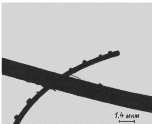
Рис. 17. Иллюстрация конденсации одинаковых по размерам частиц на фильтре, расположенных на равном расстоянии друг от друга при воздействии плазменных сгустков на С-С-композите.
