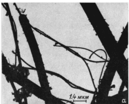
Рис. 8. Электронные микрофотографии фильтра с графитовым осадком графита МПГ-8 после облучения плазменными густками W = 500 кДж/м 2 .
