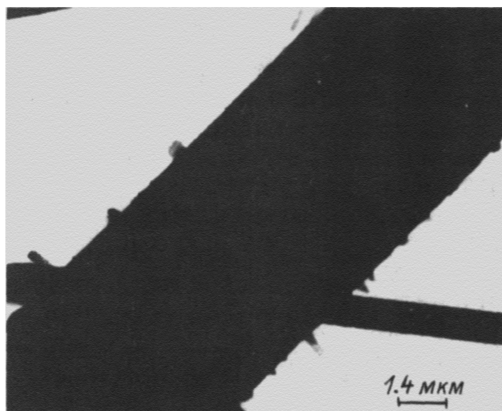
Рис. 16. Конденсация сублимированного С-С-композита на волокне в виде игольчатых выступов, W = 500 \text{ кДж/м}^2 .
