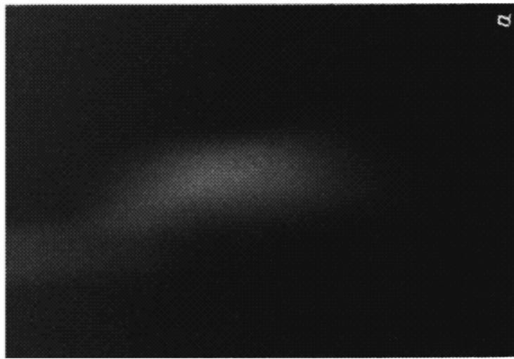
Рис. 1. Безэлектродный СВЧ разряд в воздухе.
